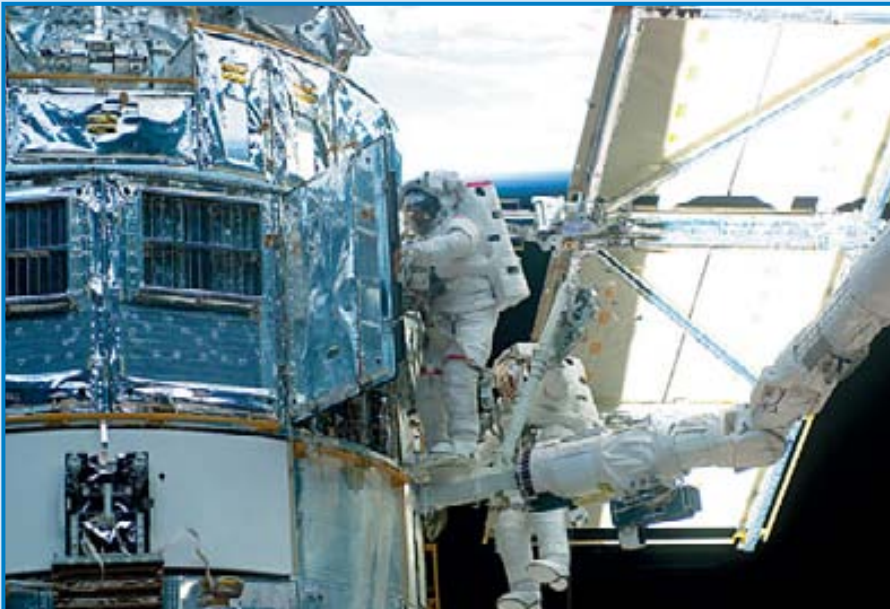
Третий выход. Замена блока PCU на «Хаббле». Слева: Джон Грунсфелд готовит хирургический инструмент к «операции на сердце»
