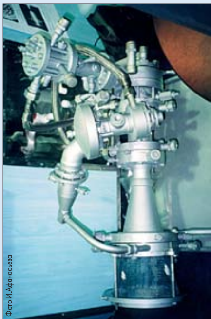
Кислородно-метановый ЖРД Центра Келдыша для исследования элементов камер крупномасштабных метановых двигателей
