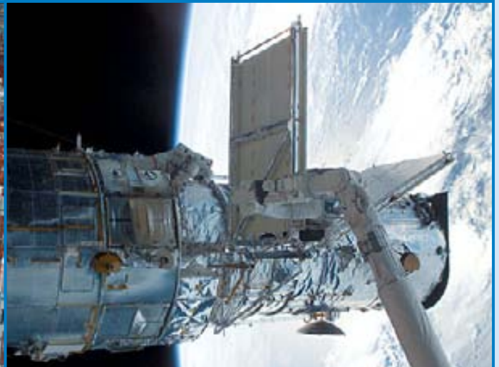
Монтаж новой солнечной батареи
