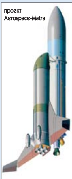
Двухступенчатый носитель с возвращаемым крылатым жидкостным ускорителем и одноразовой криогенной ступенью – центральным блоком от Ariane 5
