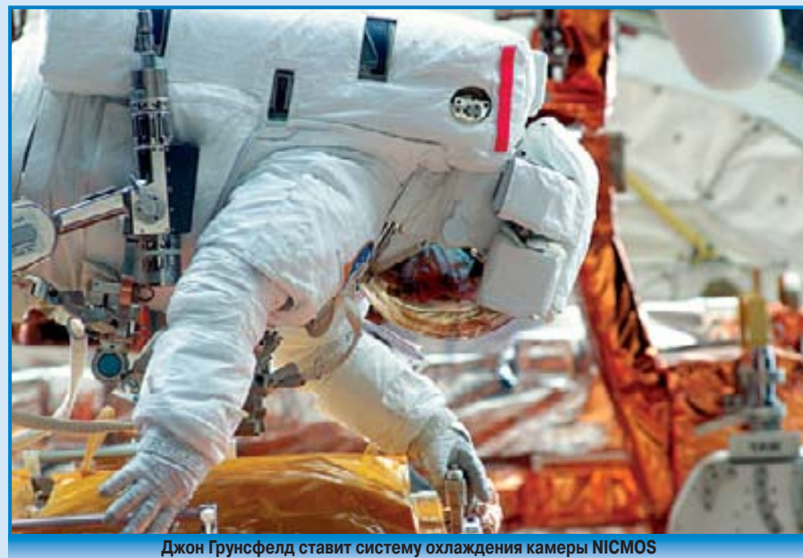
Джон Грунсфелд ставит систему охлаждения камеры NICMOS
