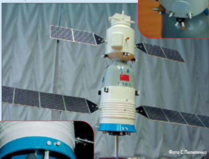
На макете корабля «Шэнь Чжоу» видны некоторые детали «короны» датчиков на орбитальном отсеке и характерные элементы двигательной установки
