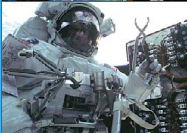
Третий выход. Замена блока PCU на «Хаббле». Слева: Джон Грунсфелд готовит хирургический инструмент к «операции на сердце»
