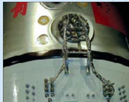
Детали корабля «Шэнь Чжоу» с выставки в Гонконге: гермоводы в спускаемый аппарат
