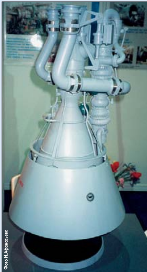
НК-33-1 отличается от прототипа раздвижным сопловым насадком, шарнирным подвесом и входными трубопроводами
