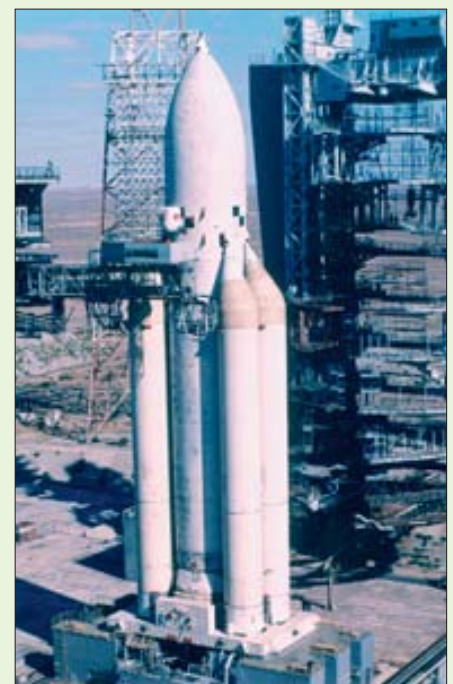
Изделие 5С перед огневыми испытаниями. Обратите внимание на «гладкие» ускорители первой ступени
