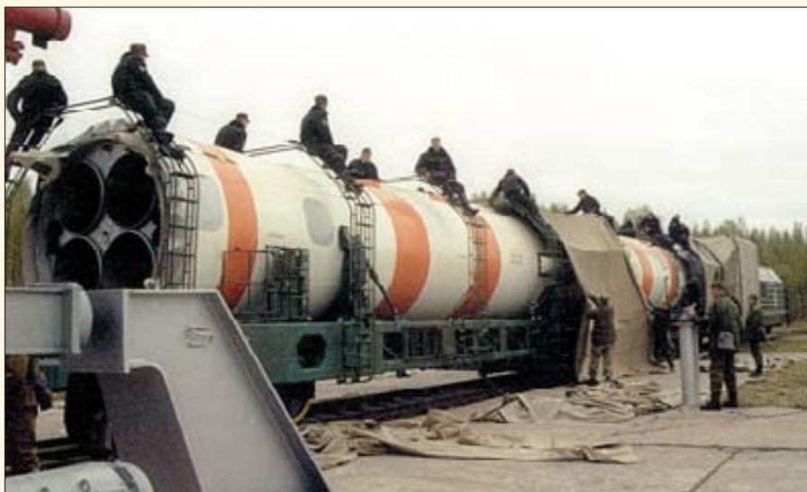
Ракету перед установкой необходимо расчехлить
