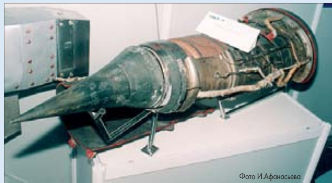
Вот что осталось от ГПВРД лаборатории «Холод» после приземления
