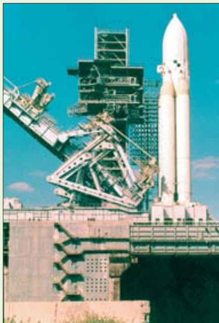
Заправка «Энергии» и предстартовые операции отработывались на стенде-старте с использованием изделий 4М и 4МКС-Д
