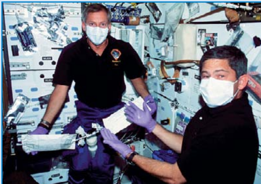
Кокрелл и Локхарт испытывают биотехнологическую систему ультраочистки воды, производимой топливными элементами шаттла (эксперимент DTO 694)
