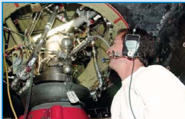
Тот самый проблемный регулятор давления наддува азотом ДУ OMS
