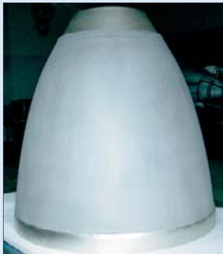
Сопло двигателя COBRA, в масштабе 40% от натурального
