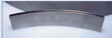
Сечение соплового насадка с фрезерованными каналами
