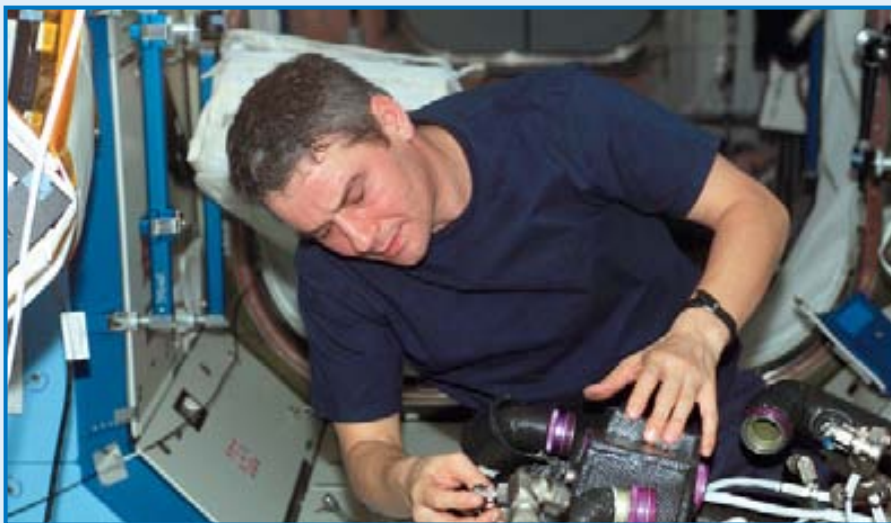
Валерий Корзун ремонтирует американский блок CDRA
