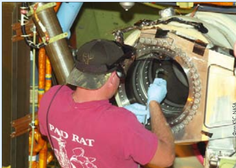
Идут работы по проверке того самого flow liner в топливной системе шаттла
