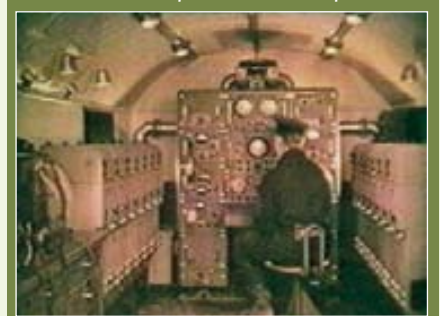
Пульт и фотоблоки станции «Трал»
