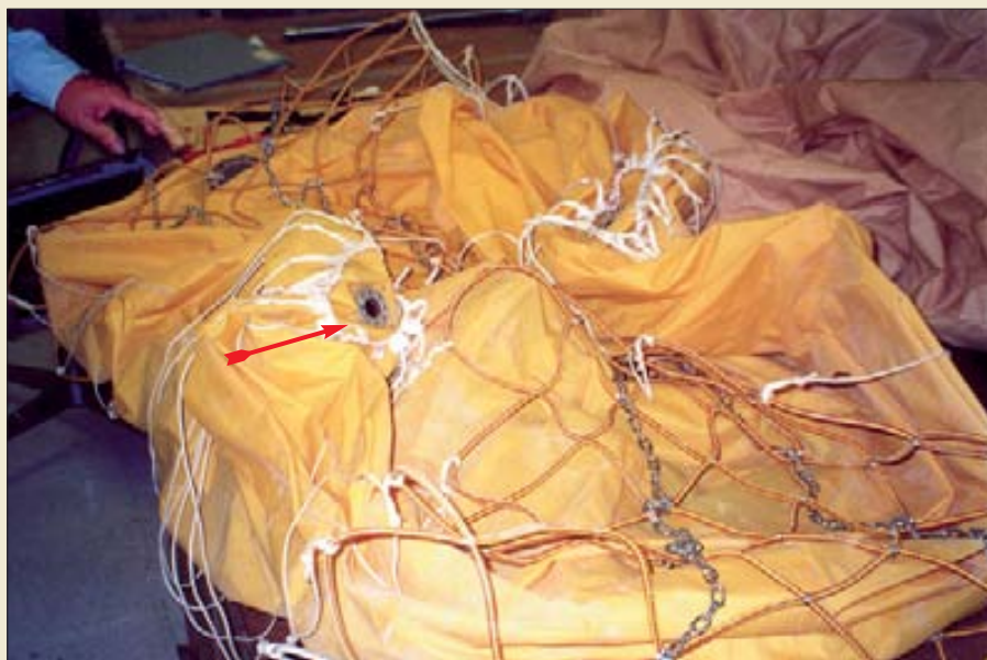
Надувная оболочка исследовательского аппарата по изучению Марса типа «перекати-поле» (приборный отсек закреплен внутри баллона на растяжках). Стрелкой показан объектив видеокамеры на поверхности оболочки
