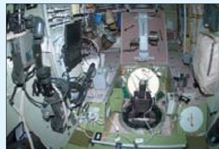
Аппаратура для проведения экспериментов по программе «Релаксация» на борту МКС, установлена на иллюминаторе №9 СМ. Снимок сделан в апреле 2002 г.
