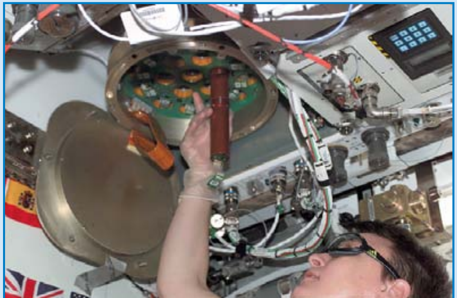
Пегги Уитсон выгружает картриджи с выращенными кристаллами из печи ZCG
