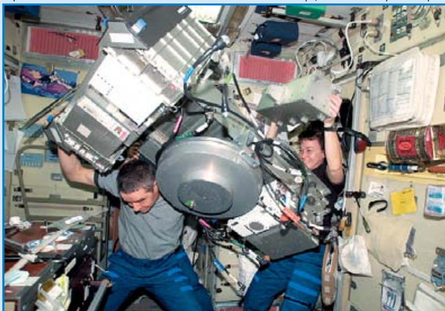
Командир и бортинженер устанавливают виброизолирующую платформу для беговой дорожки TVIS. Вес нулевой, но масса приличная!
