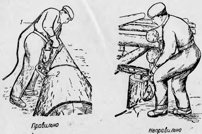
Рис. 14. Правильное и неправильное месторасположение питающего провода.
