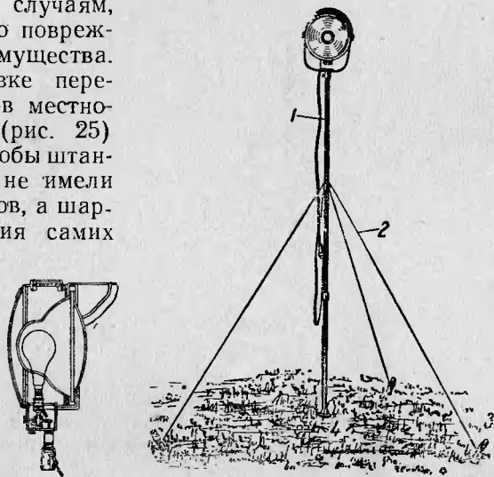
Рис. 24. Прожектор заливающего света (слева) и установка его на разборной переносной мачте (справа).
