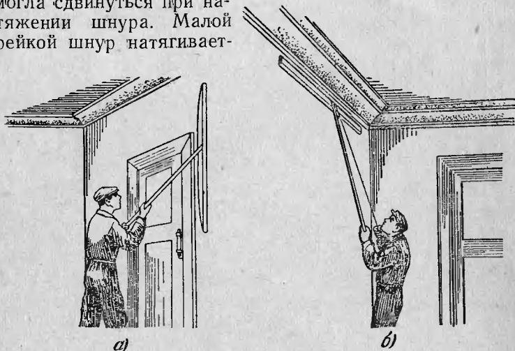
Рис. 6. Отбивка с помощью специального приспособления линий электропроводок. а — вертикальных; б — горизонтальных линий.
