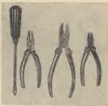
Рис. 12. Инструменты с изолированными рукоятками.
