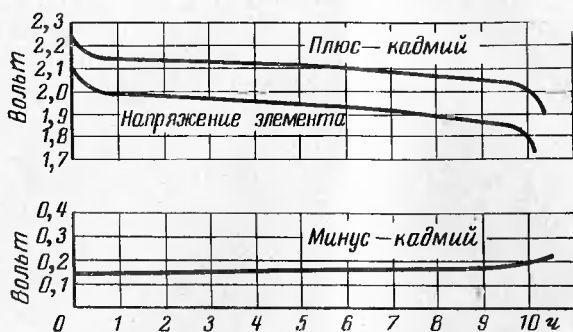
Рис. 39. Кривые напряжения при разряде аккумуляторов с дефектными положительными пластинами.
