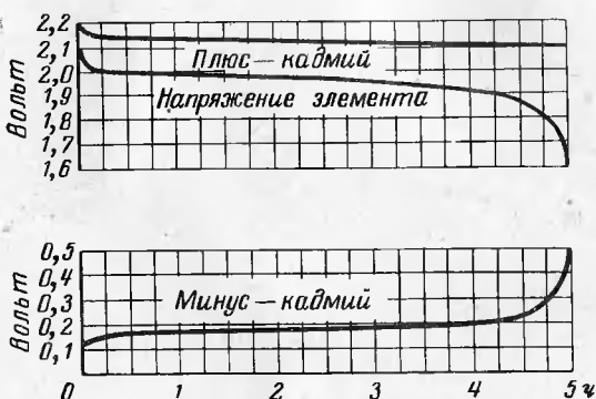
Рис. 40. Кривые напряжения при разряде аккумуляторов с дефектными отрицательными пластинами.
