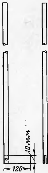
Рис. 9. Деревянный угольник для измерения уровня шлама.
