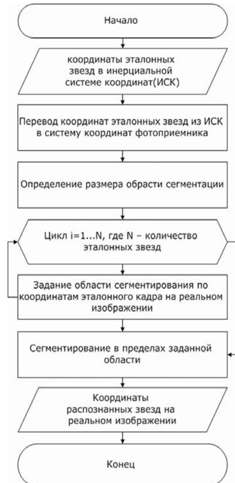
Рис. 6. Обобщенный алгоритм высокоскоростной сегментации снимка звёздного неба
