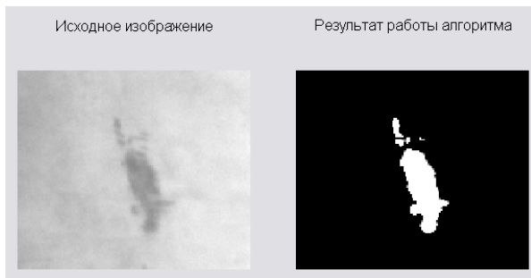
Рис. 8. Результат сегментации блока III типа
