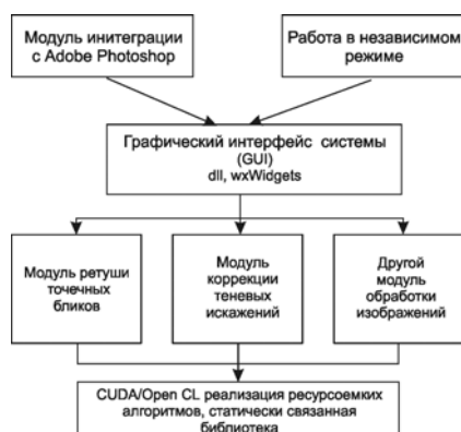
Рис. 5. Архитектура программного комплекса
