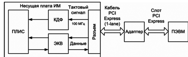
Рис. 3. Реализация интерфейса PCI Express
