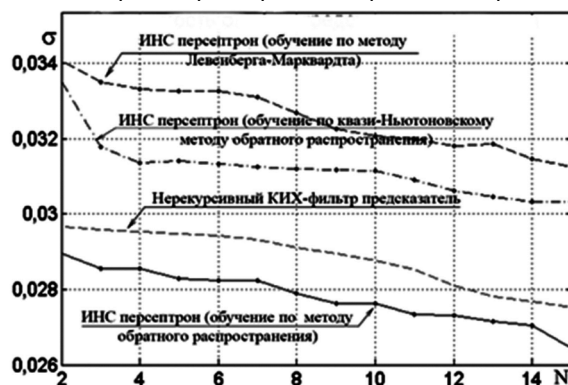
Рис. 6. Зависимости среднеквадратичной ошибки предсказания от порядка предсказателя для ИНС типа многослойный перцептрон
