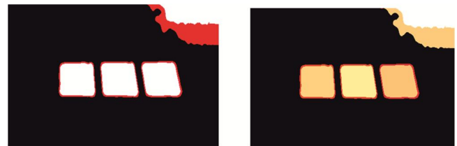
Рис. 5. Тепловое изображение в цвете после сегментации в матрице Z_2 и тепловое изображение в сегментах матрицы Z_1 , полученные алгоритмами 2 и 3 с фильтром Винера
