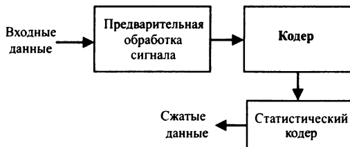
Рис. 3.3. Обобщенная схема алгоритма сжатия МКС
