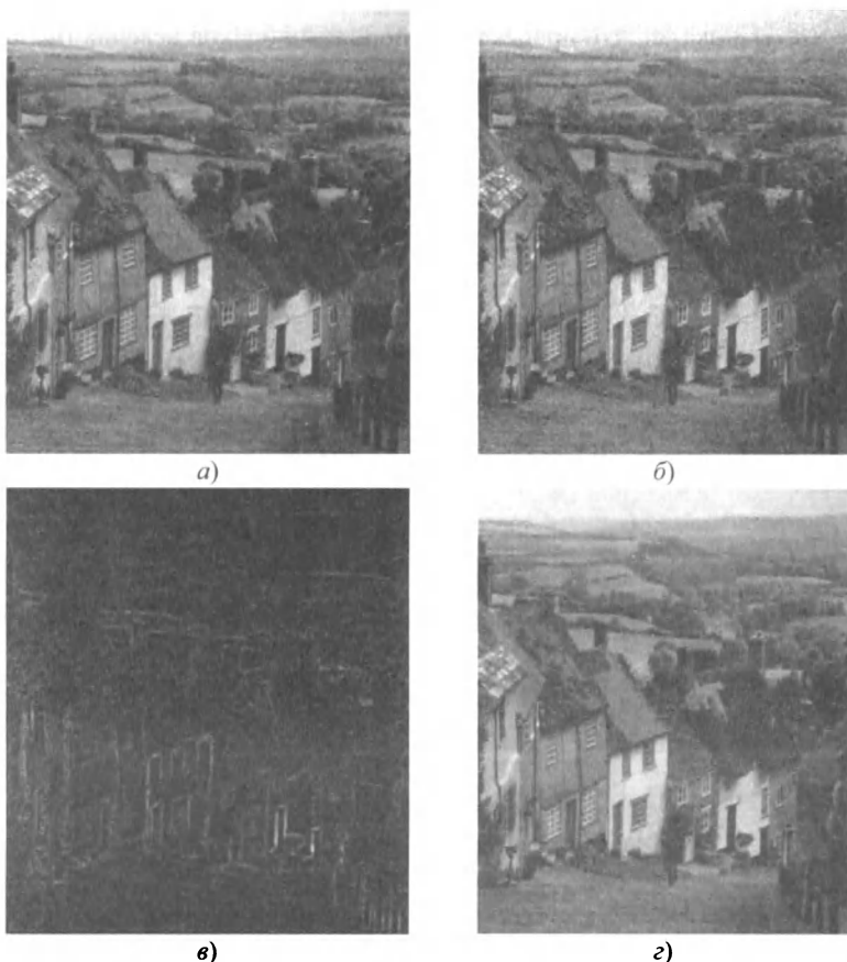
Рис. 2.9. Исходное изображение Goldhill (а), его зашумленная версия (б), визуализированные значения параметра E^{\text{DCT}}(n, m) (в) и изображение после фильтрации (г)
