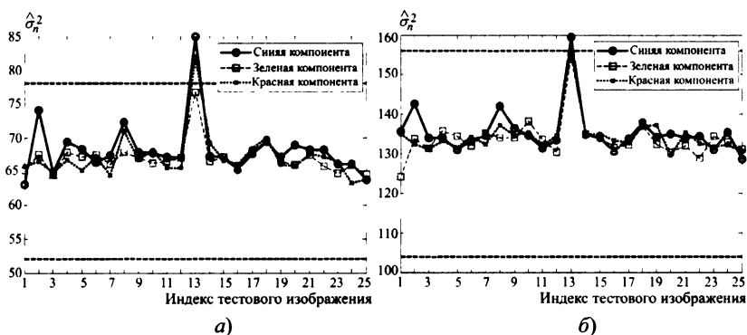
Рис. 1.9. Оценки дисперсии шума, полученные методом ОДКП [20] для набора тестовых изображений, искаженных пространственно некоррелированным аддитивным шумом с дисперсиями \sigma_n^2 = 65 (а) и \sigma_n^2 = 130 (б)
