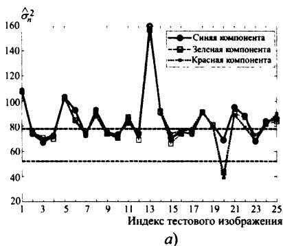
Рис. 1.8. Оценки дисперсии шума, полученные методом ОДВО для набора тестовых изображений, искаженных пространственно некоррелированным аддитивным шумом с дисперсиями \sigma_n^2 = 65 (а) и \sigma_n^2 = 130 (б)
