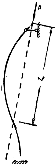
Рис. 7. Форма искривления упругого стержня
