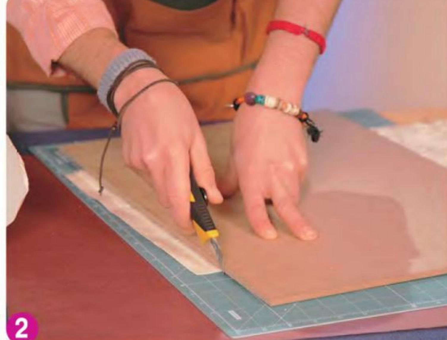
лист МДФ, то приклеиваем его так, чтобы по периметру подноса оставался одинаковой ширины бортик. Прижимаем как следует и ждём полного высыхания.
