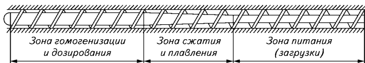
Рис. 3.1. Разделение шнека на три зоны по стадиям технологического процесса
