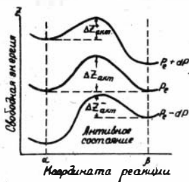
Рис.8. Свободная энергия активации при трех различных давлениях для реакции \alpha \rightarrow \beta . Иллюстрация изменения скорости реакции выше и ниже равновесного давления.
