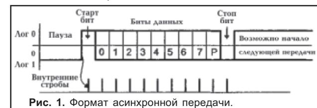
Рис. 1. Формат асинхронной передачи.
