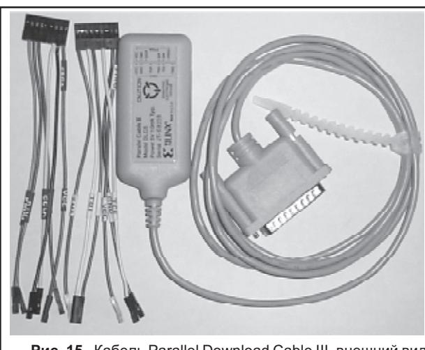
Рис. 15. Кабель Parallel Download Cable III, внешний вид
