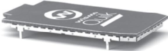
Серия Q24xx представляет собой базовые модели модемов WAVECOM третьего поколения. Q24xx – это двухканальные GSM/GPRS модули (Е-GSM/GPRS 900/1800 МГц), совместимые со стандартом «ETSI GSM Phase 2+» (GSM/GPRS, класс 10). Модули Q24xx не являются полностью законченными изделиями. Они должны быть интегрированы в прикладное устройство с применением дополнительных компонентов, таких, например, как источник питания, держатель SIM- карты, антенна, соединительный кабель последовательного порта.
