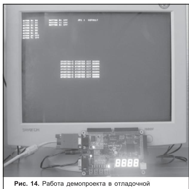
Рис. 14. Работа демопроекта в отладочной плате Spartan-3 StarterKit.
