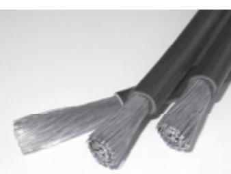
Резка проводов больших диаметров и сечений до 95мм<sup>2</sup> осуществляется при помощи пневматической режущей головки с усилием резания 10кН. В режущей головке применяются V-образные ножи,
