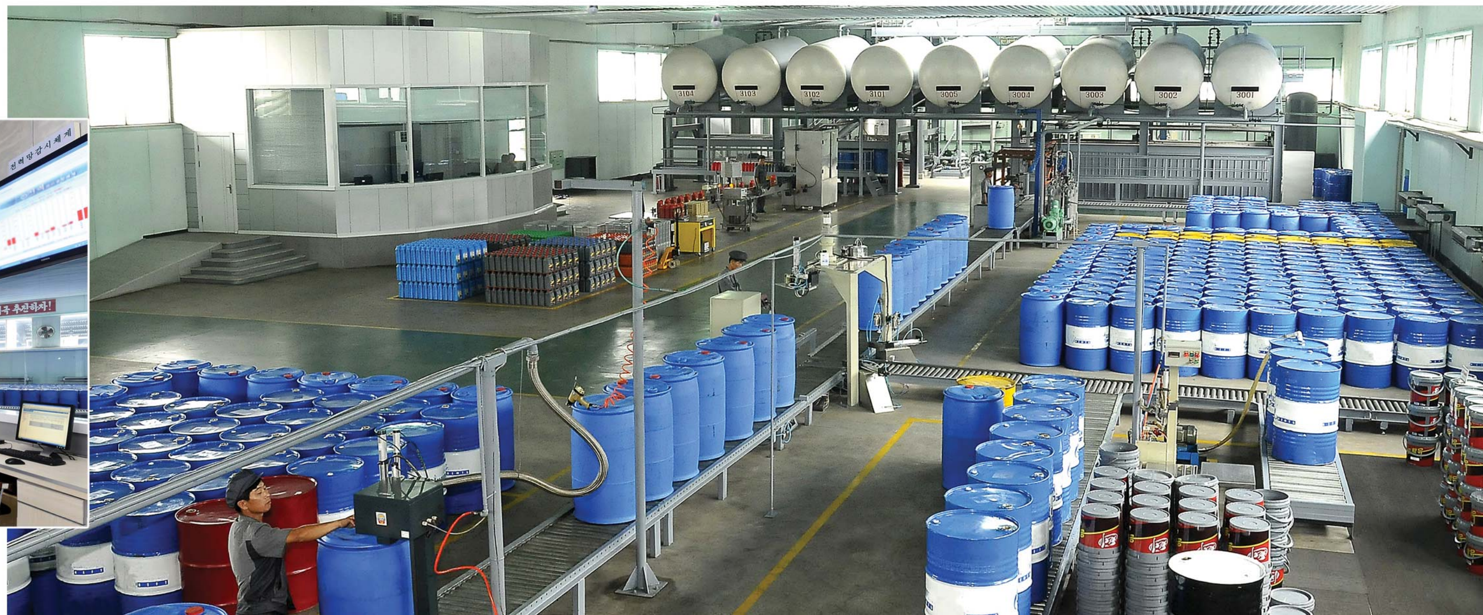
Компьютерами контролируются и управляются все процессы – взвешивание сырья, смешивание, упаковка и др.
