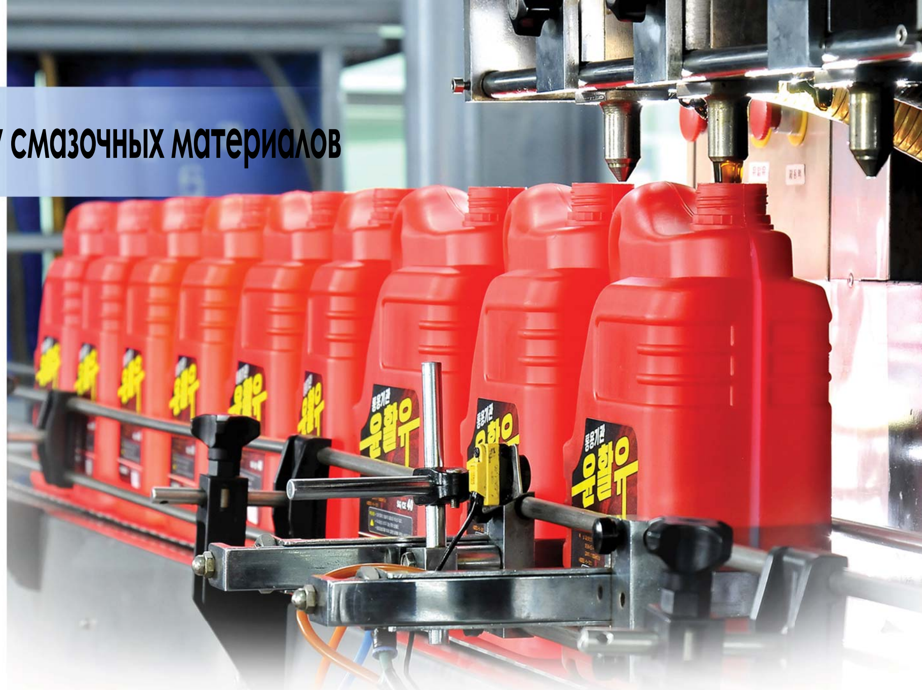
Компьютерами контролируются и управляются все процессы – взвешивание сырья, смешивание, упаковка и др.
