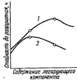
Рис. 61. Влияние содержания легирующих элементов на время до разрушения образцов [75]: 1 — плавка в вакууме; 2 — обычная плавка
