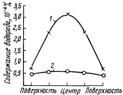
Рис. 112. Распределение водорода по поперечному сечению крупных поковок:
