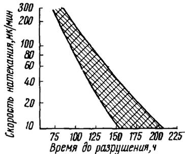
Рис. 59. Влияние величины натекания на длительную прочность сплава Ю500 (80)
