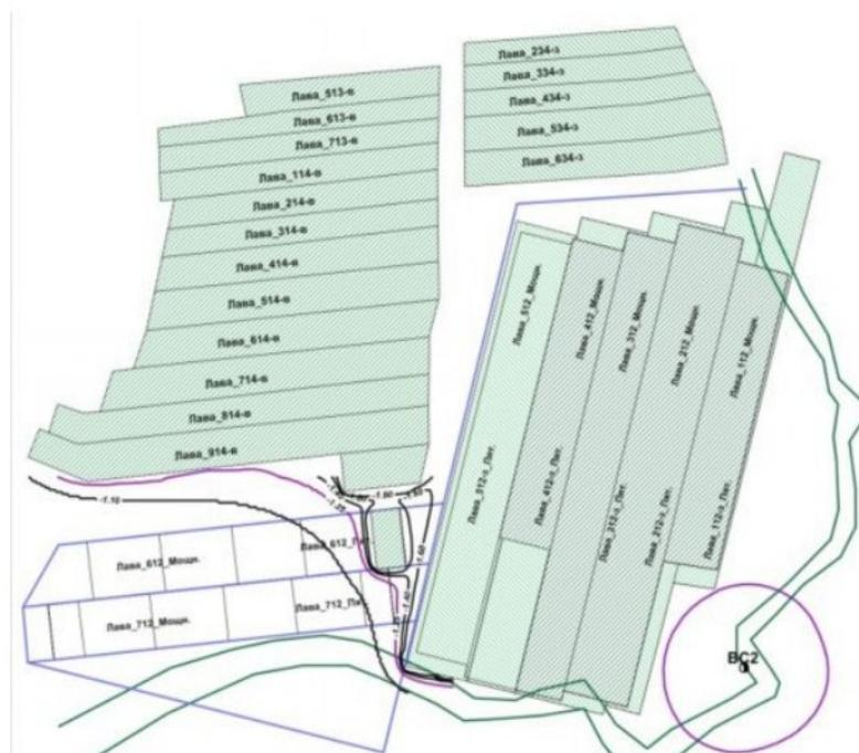
**Рис. 5. Зона ПГД на пласте “Пятыj” после первого этапа отработки лавы 612 пласта “Пятыj”**
