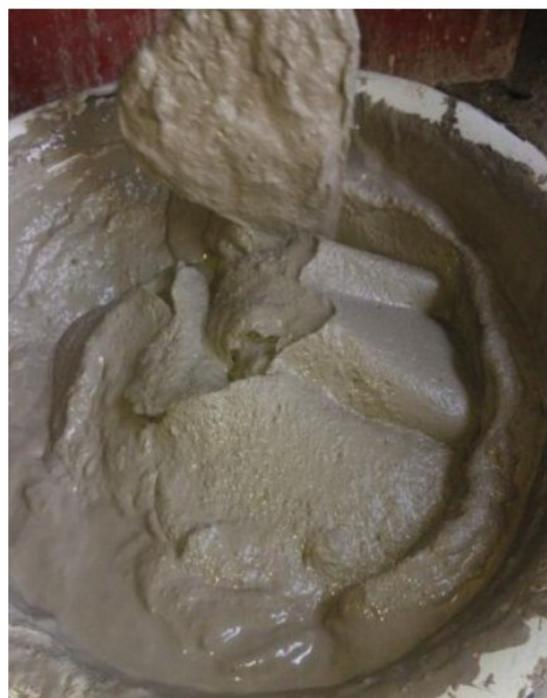
Рис.2. Закладочная смесь, получаемая в результате подачи смеси диабазов и клинкера в дробилку КИД-300
