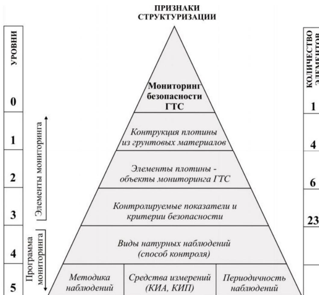
**Рис. 1. Схема структуризации мониторинга безопасности ГТС**
