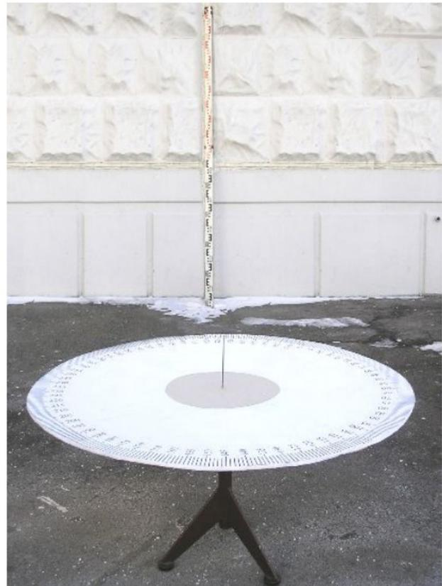
Рис.3. Действующий макет античного измерительного круга
