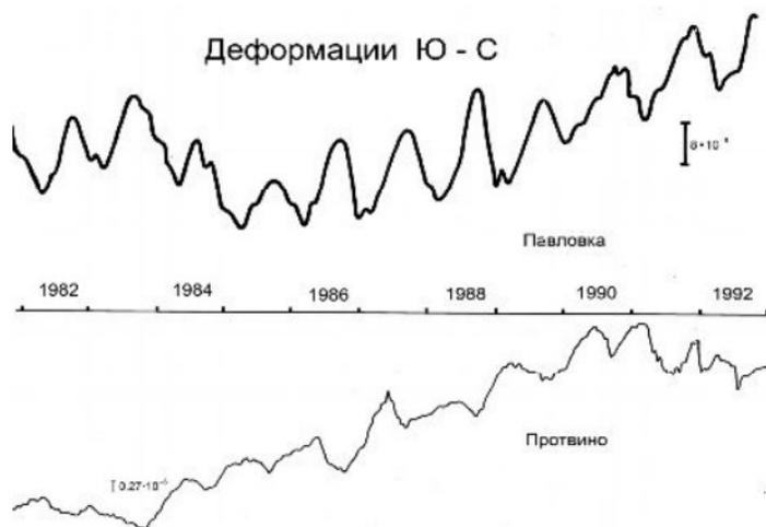
**Рис.2. Ход горизонтальных деформаций земной поверхности на двух станциях Протвинского полигона в течение 11 лет**
