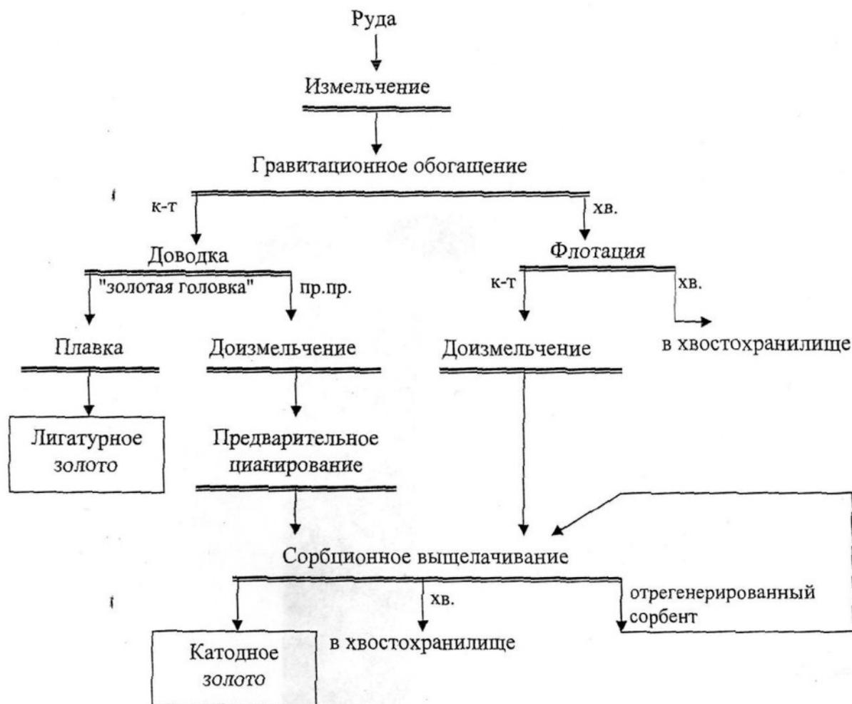
**Рис.1. Схема переработки руды месторождения Сухой Лог**
