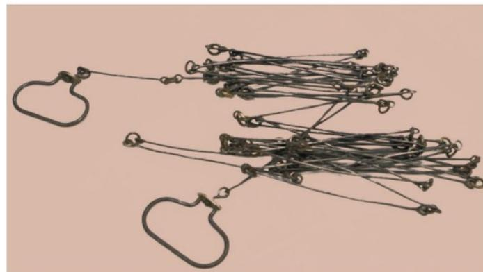
Рис. 7. Мерная цепь, пятидесятизвенная. Западная Европа, нач. XX в. (музей ЗАО «Геостройизыскания»)
