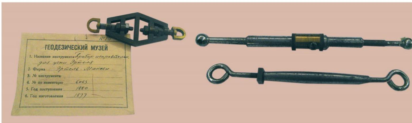
Рис. 10. Инструмент для исправления цепи с возможностью регулировки длины
