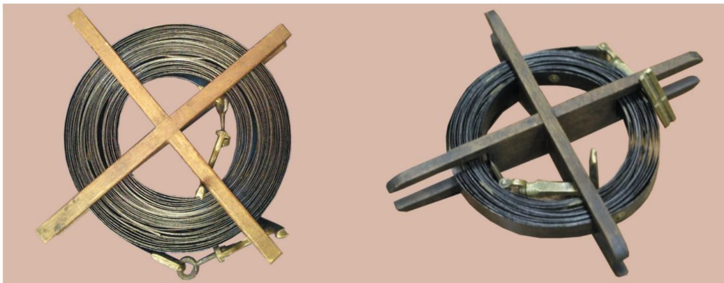
Рис. 11. Слева: десятисаженная мерная лента, с двумя отремонтированными, заклепанными участками. Франция, фирма «Jourdain», 1874 (музей КМИ (МИИГАуК)). Справа: 10-метровая, США, Бостон, фирма «Full & Full», конец XIX в. (музей ЗАО «Геостройизыскания»)
