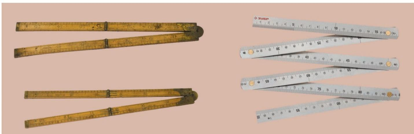
Рис. 3. Слева: конструкция деревянных складных линеек аршинной (слева сверху) и двухфутовой (слева снизу, пр-во Д.Рабона, Англия) практически одинакова (музей ММД).
