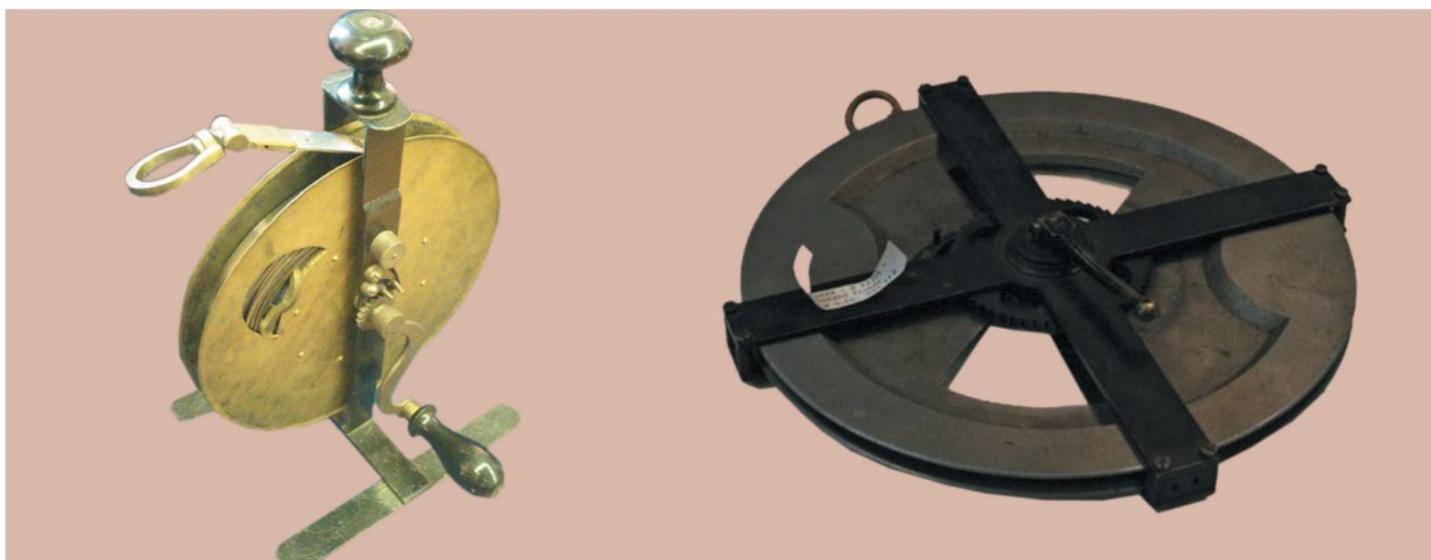
Рис. 13. Слева: десятисаженная мерная лента на полустационарной бобине, полусажени отмечены кружком, сажени нечетные ромбом, четные квадратом, центральная – прямоугольником с цифрой «5», Германия, «Gamke in Glogau», начало XX в. (музей КМИ (МИИГАиК)). Справа: 26-метровая стальная лента, в отличие от предыдущих шириной в 6 мм и без отверстий для шпилек. Германия, Hildebrand, 1920–1930-е гг. (музей ЗАО «Геостройизыскания»)
