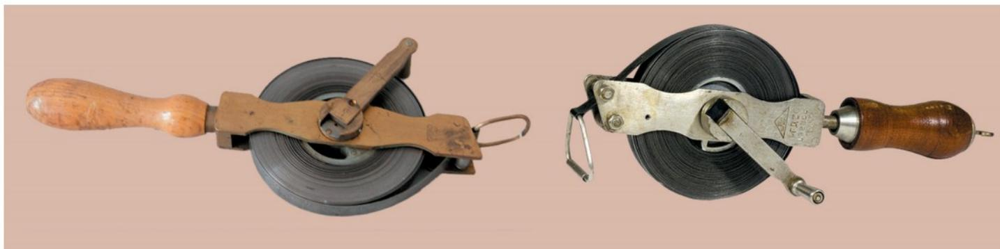
Рис. 15. Слева: стальная мерная лента, 30-метровая, Польша, Варшава, Г. Герлях, 1920-е гг. (Политехнический музей). Справа: стальная мерная лента (рулетка) РГД-30 (30-метровая), СССР, Таганрог, завод Измерительных приборов, 1960 г. (ММД)
