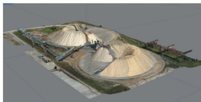
Рис. 5. Изображение 3D-модели кучи песка на открытом складе в интерфейсе «Agisoft PhotoScan Pro»
