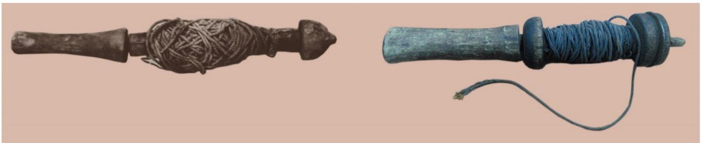
Рис. 2. Слева: мерный шнур (также использовался как разметочный шнур и отвес) Древнего Египта [5]. Справа: демонстрационная катушка с веревкой Политехнического музея, приобретенная на рынке старой хозяйственной утвари
