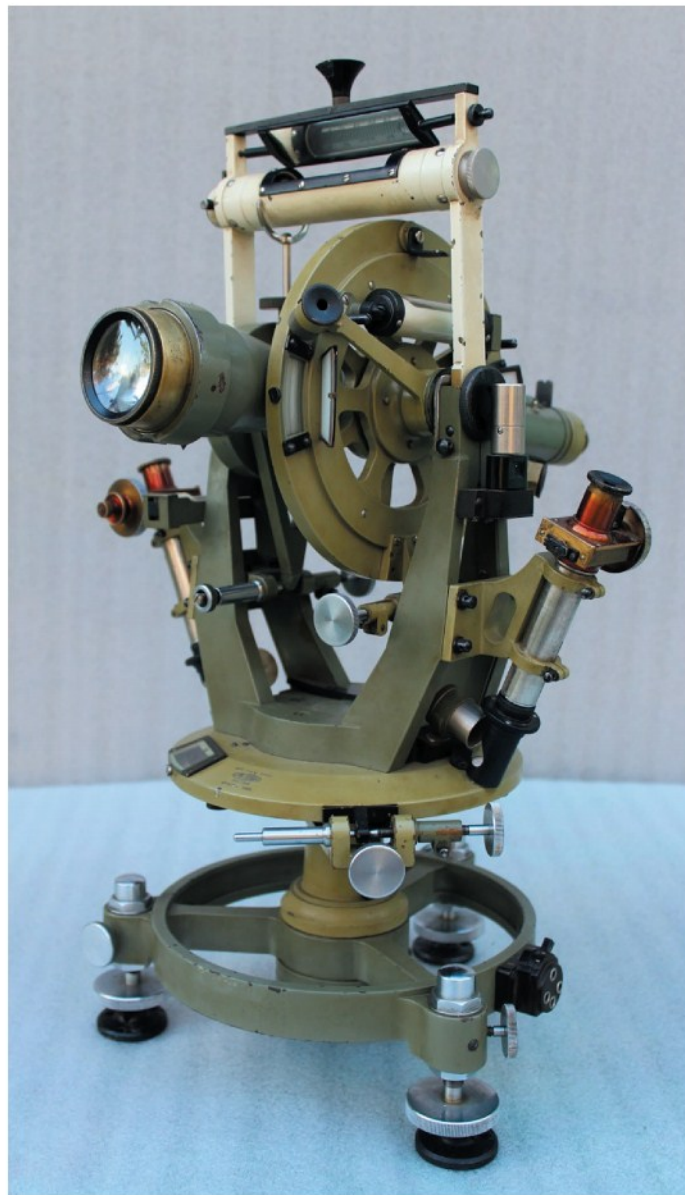
Рис. 1. Триангуляционный теодолит ТТ 5/10
