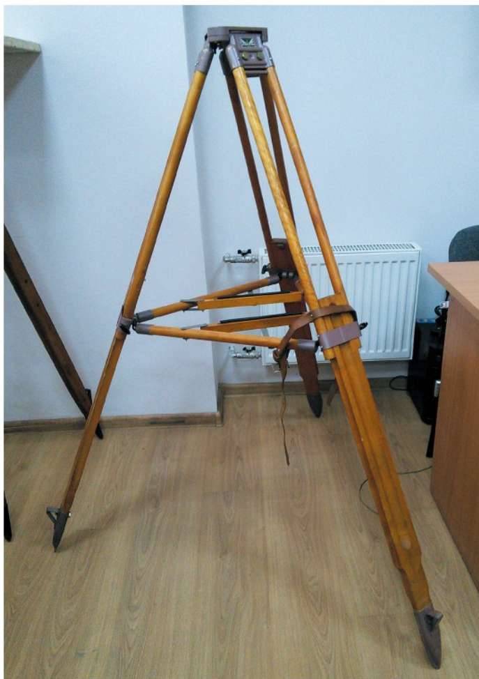
Рис. 3. Штатив с дополнительной раскладывающейся треугольной опорной рамой
