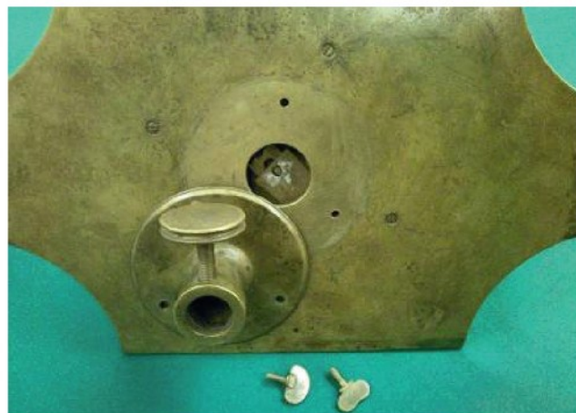
Рис. 5. Буссоль с разнесенными диоптрами и со съемной установочной втулкой. Германия, Берлин, Ring Berlin, середина XIX века. Музей МИИГАиК (КМИ-1715)
