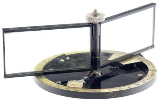
Рис. 14. Угломер зеркальный Ефремова маркшейдерский ЗУ-1. СССР, Харьков, ЗМИ (з-д маркшейдерских инструментов), 1949. Музей ООО «Геостройизыскания» (ГСИ-677)
