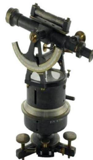
Рис. 13. Пантометр геодезический. Российская империя, Москва, М. Таубер, К. Цветков и К, 1913–1917 годы. Политехнический музей (ПМ-20362)
