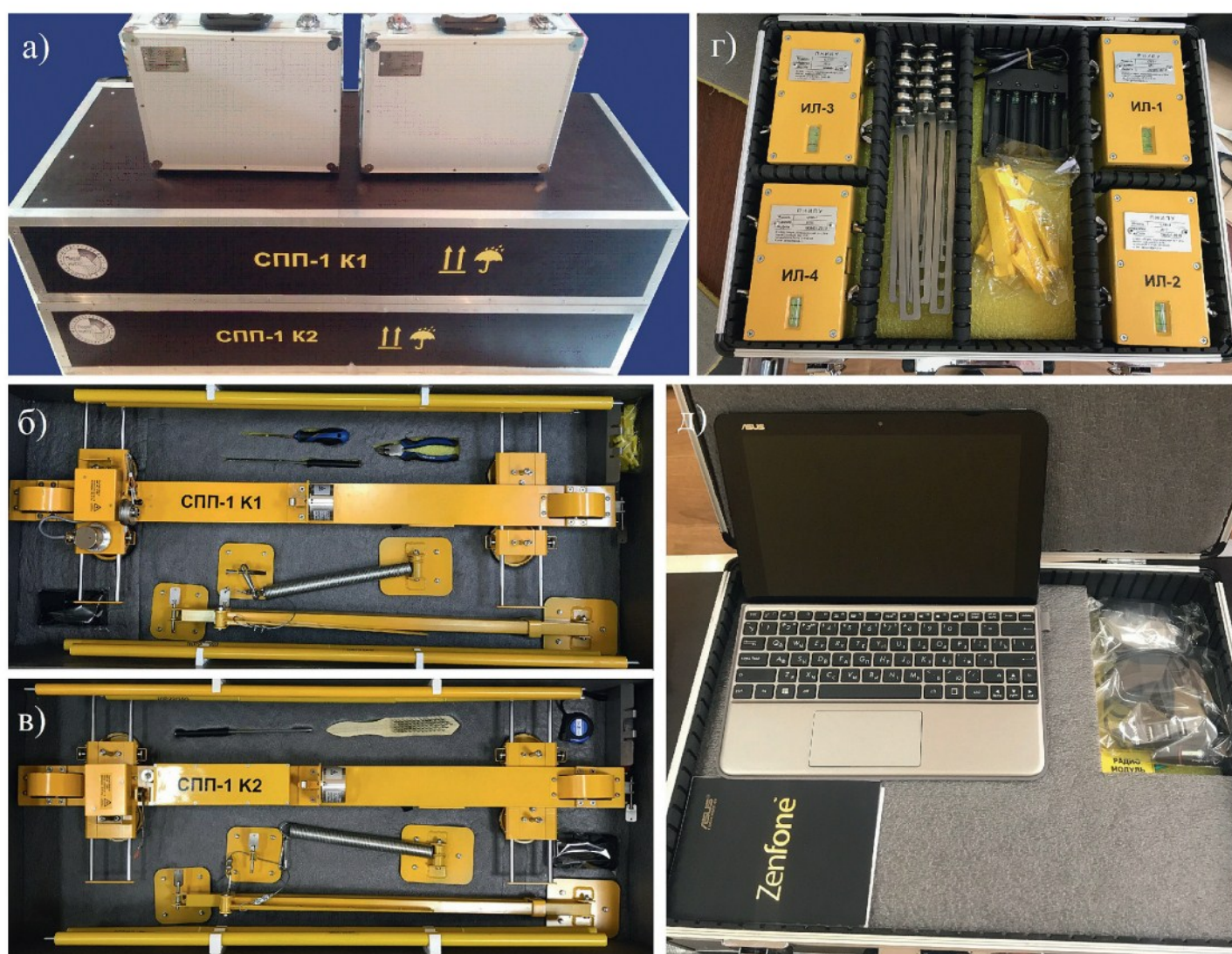
Рис. 1. Общий вид кареток К1, К2 и фиксаторов: а – общий вид станции в транспортировочных ящиках; б – общий вид каретки К1; в – общий вид каретки К2; г – общий вид фиксаторов ИЛ-1 – ИЛ-4; д – общий вид модуля управления
