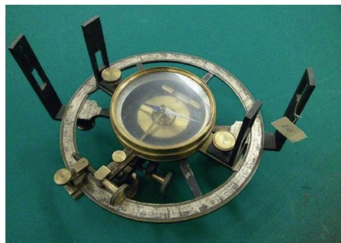
Рис. 9. Астролябия геодезическая на баксе. Российская империя, С.-Петербург, А. Шперлинг, 1844 год. Музей МИИГАиК (КМИ-315).
