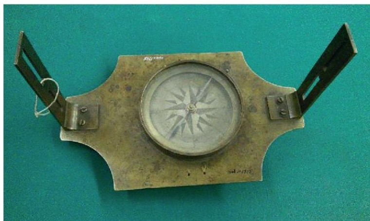
Рис. 5. Буссоль с разнесенными диоптрами и со съемной установочной втулкой. Германия, Берлин, Ring Berlin, середина XIX века. Музей МИИГАиК (КМИ-1715)
