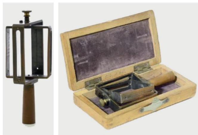
Рис. 6. Экер складной. Российская империя (?), начало XX века. Музей ООО «Геостройизыскания» (ГСИ-307)
