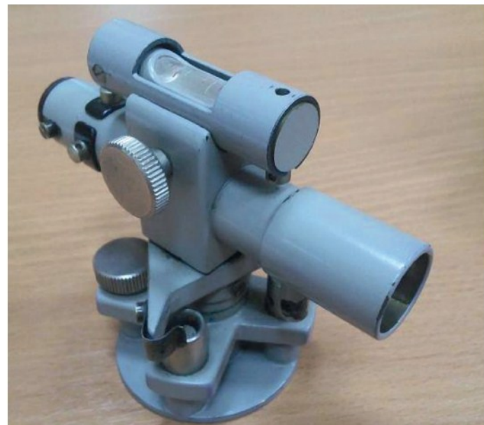
Рис. 4. Нивелир миниатюрный с ортогональным фиксатором угла поворота трубы. Великобритания, Йорк, Cooke, Troughton & Simms, 1933 г. Музей маркшейдерского дела (ММД-260)
