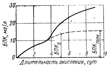
Рис. 17. Графическое определение BPK_5 и BPK_{полн} при развитии ранней нитрификации
