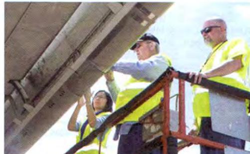
эффективных образцов. Они были размещены на передней кромке правого крыла экспериментального Boeing 757, принадлежащего NASA.
