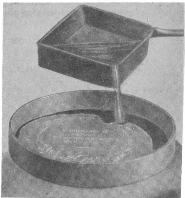
Рис. 8. Заливка восковой формы.
