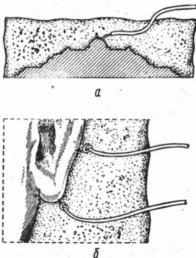
Рис. 11. Подводка проводников к углублённым местам в форме.
