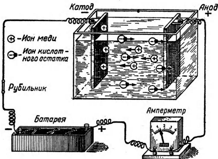
Рис. 1. Гальваническая ванна.
