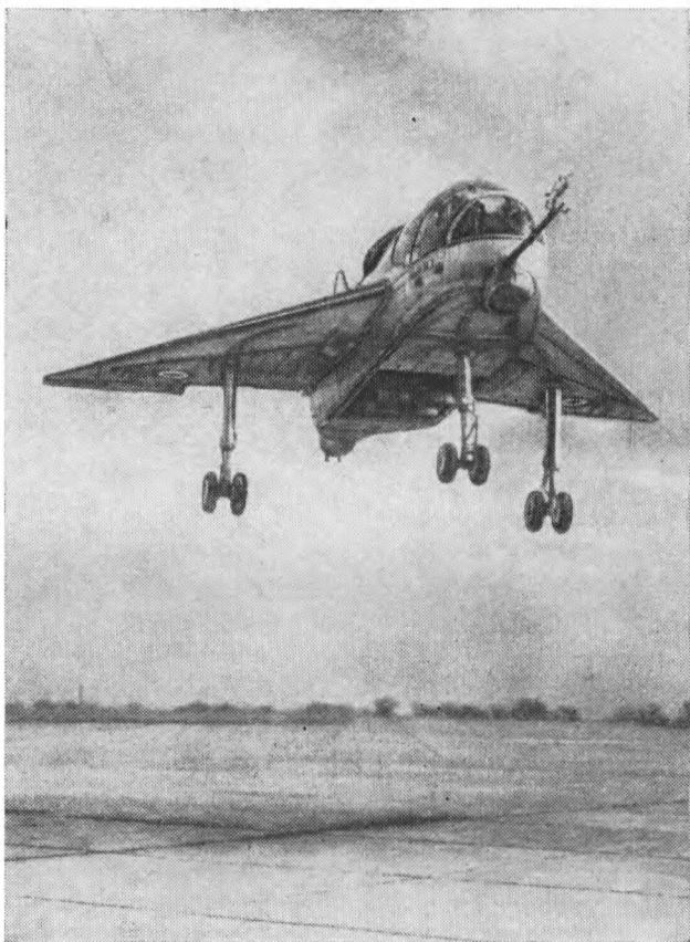
Рис. 1.20. Экспериментальный СВВП Шорт SC.1 с вертикально установленными подъемными двигателями
