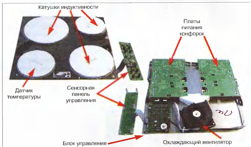
Рис. 8. Основные компоненты индукционной варочной панели
