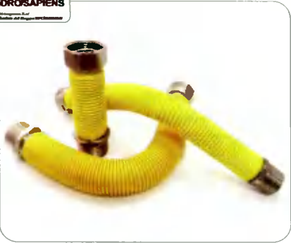
Рис. 21. Сильфонная подводка в полимерной оплетке, 1/2", 3/4", 1", гайка-гайка, гайка-штуцер
