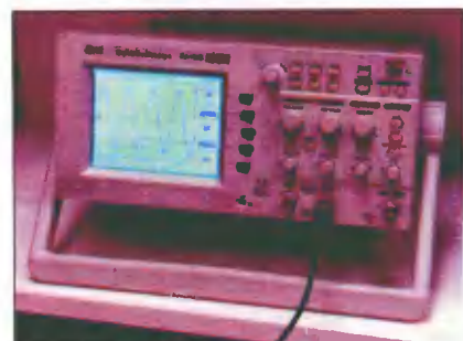
Рис. 3. Внешний вид двухканального осциллографа DS-1250 с полосой частот 250 МГц
