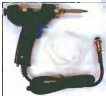
Рис. 15. Паяльник для демонтажа электронных компонентов SL-916G
