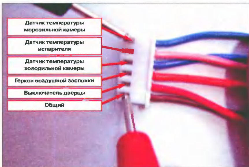
Рис. 7. Проверка датчиков на соединителе
