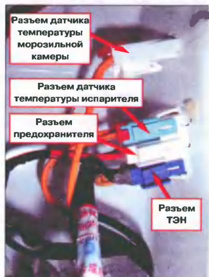
Рис. 5. Внешний вид соединителей ТЭН испарителя, а также температурных датчиков.
