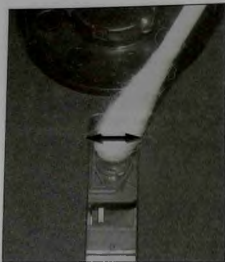
Рис. 34. Направления очистки линзы
