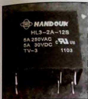
Рис. 15. Внешний вид реле HL32-2A-12S коммутации громкоговорителей
