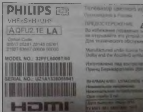
Рис. 9. Коды опций на стикере задней крышки ТВ
