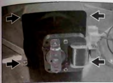
Рис. 13а. Извлечение электродвигателя вентилятора охлаждения
