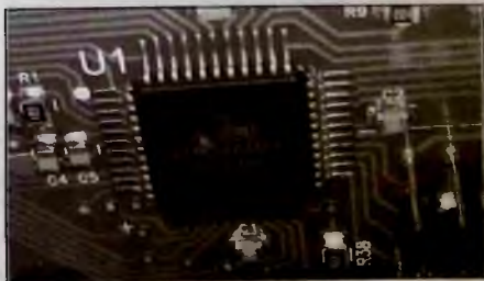
Рис. 8. Разрушение корпуса МК ПУ вследствие попадания влаги между линиями 5 В и сетевым питанием на плате основного модуля
