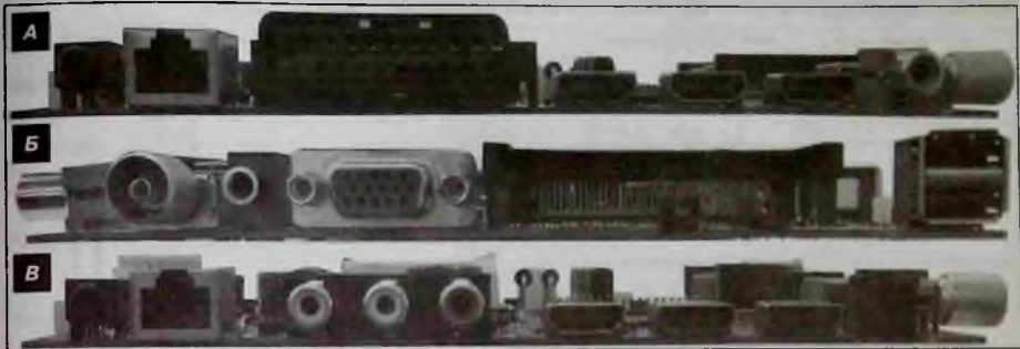
Рис. 1. Расположение разъемов на модификациях платы CV338H-U42/T42
