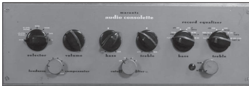
Рис. 2. Внешний вид предварительного усилителя-корректора Audio Consolette
