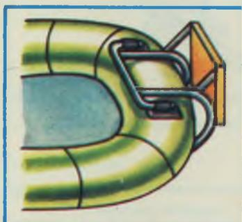
Рис. 2. Крепление транца к резиновым формовым деталям с помощью металлического кронштейна, огибающего борт.
