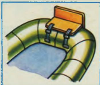
Рис. 5. Крепление транца с помощью ремней.
