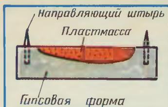
Рис. 5. Половинка формы с залитой пластмассой.
