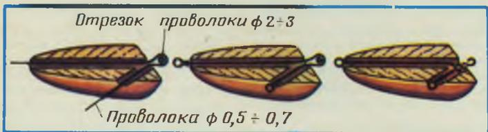
Рис. 3. Последовательность изготовления петель.
