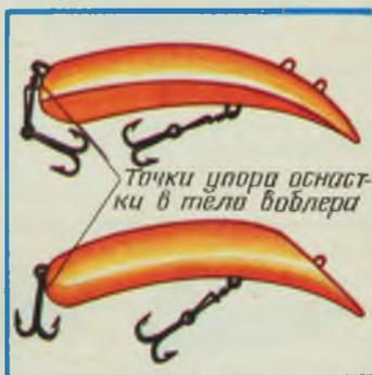
Рис. 9. Правильное расположение оснастки, исключающее сцепление тройников.
