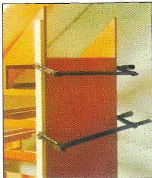
Боковую стенку спереди крепят на шкантах, а сзади — на шурупах.
