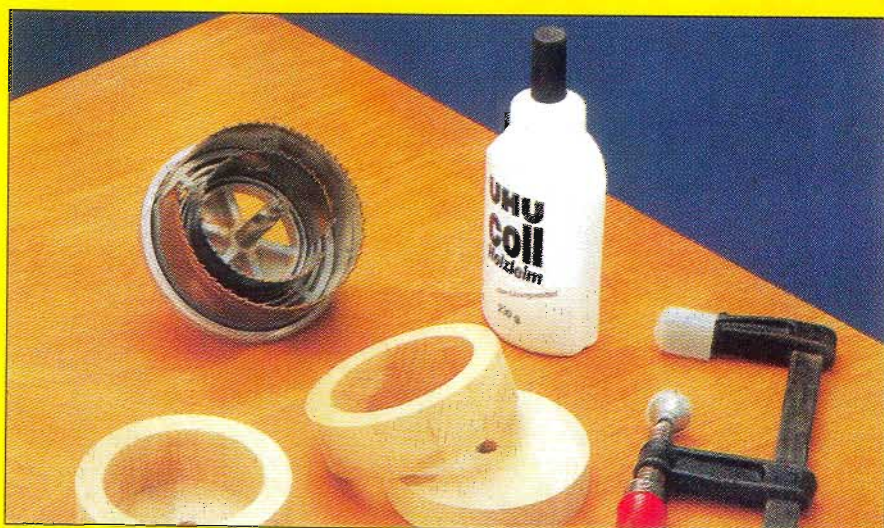
Сверлом-коронкой можно выпилить из клееной древесины стаканы ножек этажерки. Глубина стакана должна быть такой, чтобы он полностью укрывал нижнюю гайку.
