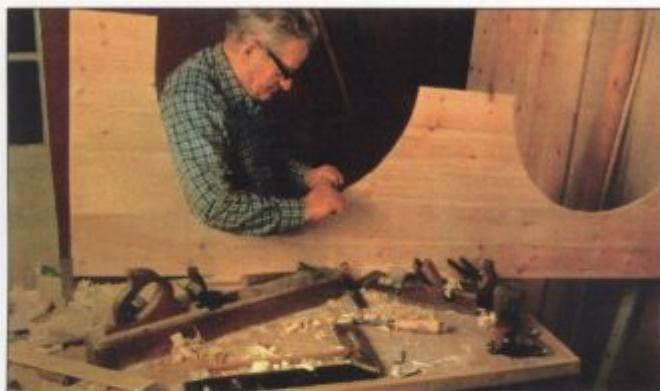
**6** С помощью скобеля удаляют неровности. При отсутствии этого инструмента можно использовать навернутую на круглый брускок наждачную бумагу. После этого элементы цоколя из ДСП привинчивают к стенкам кровати.
