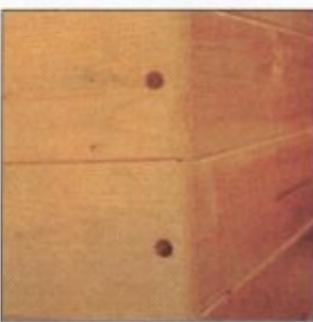
**9** В торцах боковых досок сверлят отверстия Ø 6 мм, глубиной 25 мм и вворачивают в них втулки фурнитуры. При сборке кровати во втулки ввинчивают винты, подложив под них шайбы, соединив, таким образом, все четыре стенки. Отверстия заделяют деревянными пробками.
