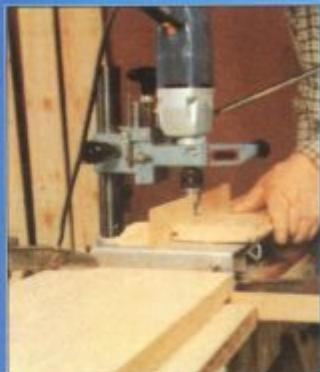
**1** Фаска, снятая с обеих сторон строганых досок, делает стенки кровати более красивыми. Эту операцию можно легко и быстро выполнить с помощью электродрели с фрезерной насадкой.
