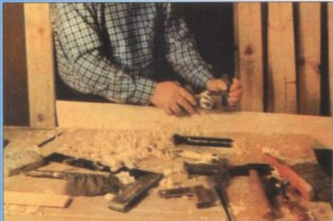
**2** Доски сортируют, подобрав для открытых глазу стенок рисунок текстуры покрасивей. Раскраивают их по длине. У верхней доски каждой из стенок убирают гребень.
