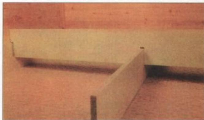
**7** Пробная сборка каркаса кровати для подгонки его элементов друг к другу, в том числе, и опорной крестовины для оснований под матрасы. Теперь можно размечать отверстия для соединения боковых стенок с передней и задней.
