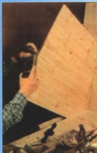
**4** Все кромки стенок кровати обрабатывают рубанком и зачищают наждачной бумагой.
