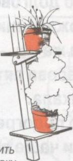
ки должны быть склеены водостойким kleem, а опорные консоли сделаны из стойкой к атмосферным воздействиям древесины, например, дуба, крепежные детали — из оцинкованного металла, нержавеющей стали или латуни.
