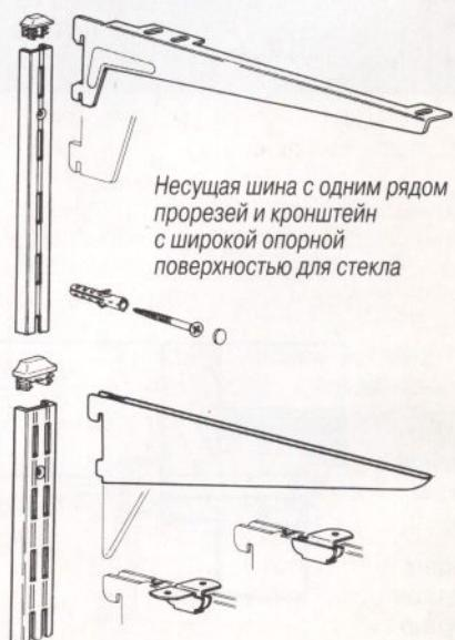
Несущая шина с одним рядом прорезей и кронштейном с широкой опорной поверхностью для стекла
