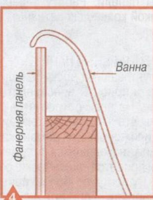
Ванна с наклонными сторонами и узкой кромкой требует более узкой рамы.
