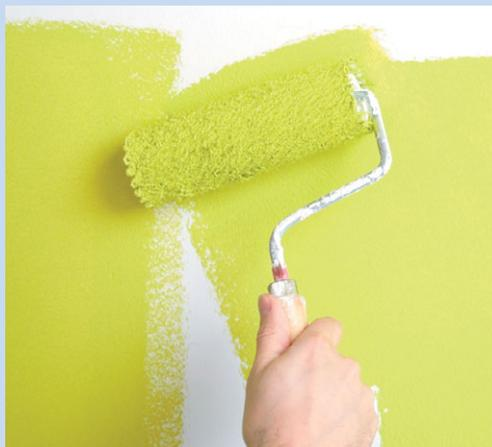
Перед длительным перерывом, например на ночь, малярный валик нужно тщательно промыть. Если его «шубку» можно снять, то лучше это сделать и постирать ее отдельно. После того как валик полностью промывает (это определяется по воде, выдавливаемой из него — она должна быть абсолютно чистой), его нужно «распушить» и повесить рукояткой вверх для просушки. Чтобы ворс на «шубке» встал равномерно, необходимо резким движением прокатать валик по чистой стене.
