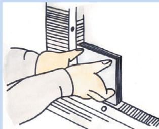
*Укладку плитки ведут вворачивающими движениями, при этом слегка вдавливая плитку в клеевой слой.*
