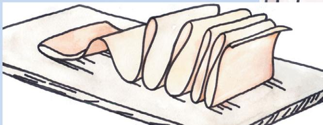
После нанесения клея обои складывают «гармошкой», клеевой стороной внутрь.
