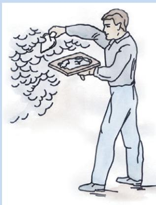
На поверхность стены штукатурный раствор наносят двумя способами: густой — намазывают, а жидкий — набрасывают. Набрасывание раствора осуществляют взмахом кельмы с последующей остановкой. При резком взмахе кельмой раствор наносится широкими и тонкими полосами, а при плавном — узкими и толстыми.
