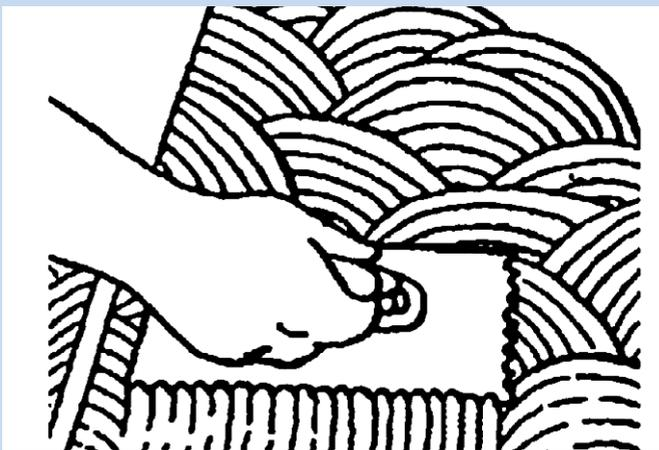
Клеевой состав наносят на основание и разравнивают зубчатым шпателем. При этом его излишки сдвигаются полотном шпателя, а на основании остается только та часть состава, которая прошла между зубчиками.
