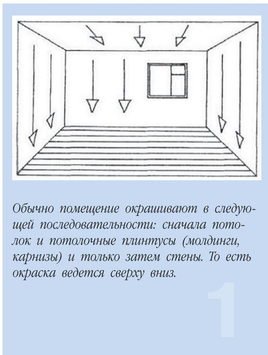
Обычно помещение окрашивают в следующей последовательности: сначала потолок и потолочные плинтусы (молдинги, карнизы) и только затем стены. То есть окраска ведется сверху вниз.
