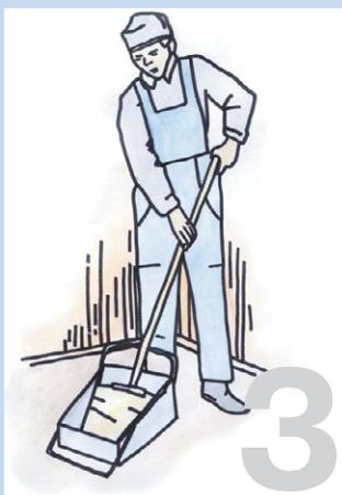
Вместо ящика можно приобрести специальную кювету для краски. Для устранения излишков и равномерного распределения краски она имеет наклоненную ребристую поверхность.
