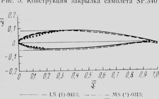
Рис. 6. Аэродинамические профили, предлагавшиеся для крыла самолета SF.340
