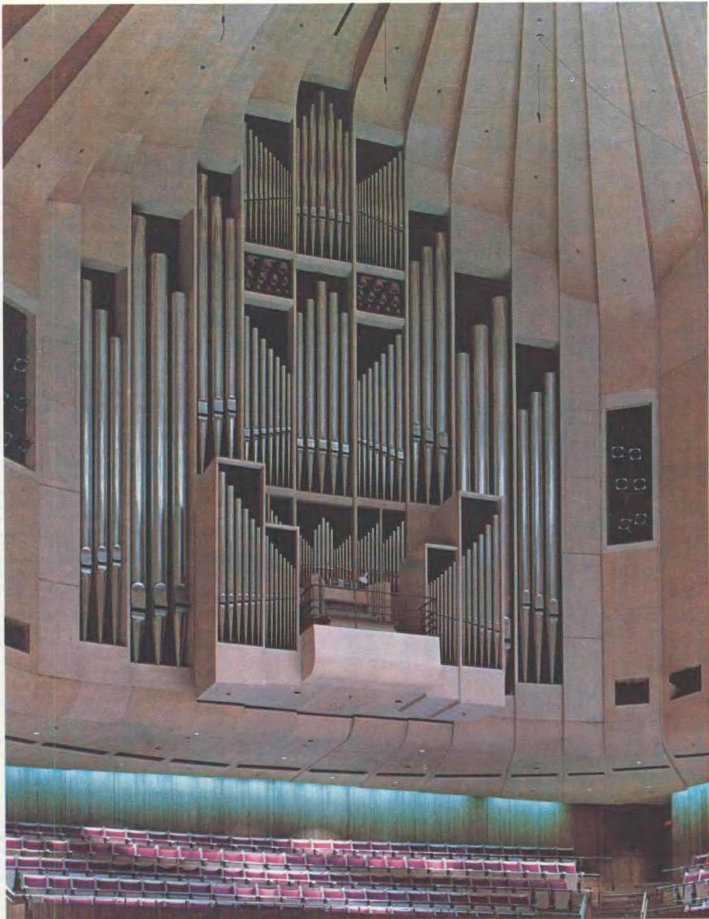
ОРГАН, установленный в 1979 г. в концертном зале Сиднейского оперного театра в Австралии, является самым большим и технически совершенным органом в мире. Спроектирован и построен Р. Шарпом. В нем имеется около 10 500 труб, управляемых с помощью механической передачи пя-
