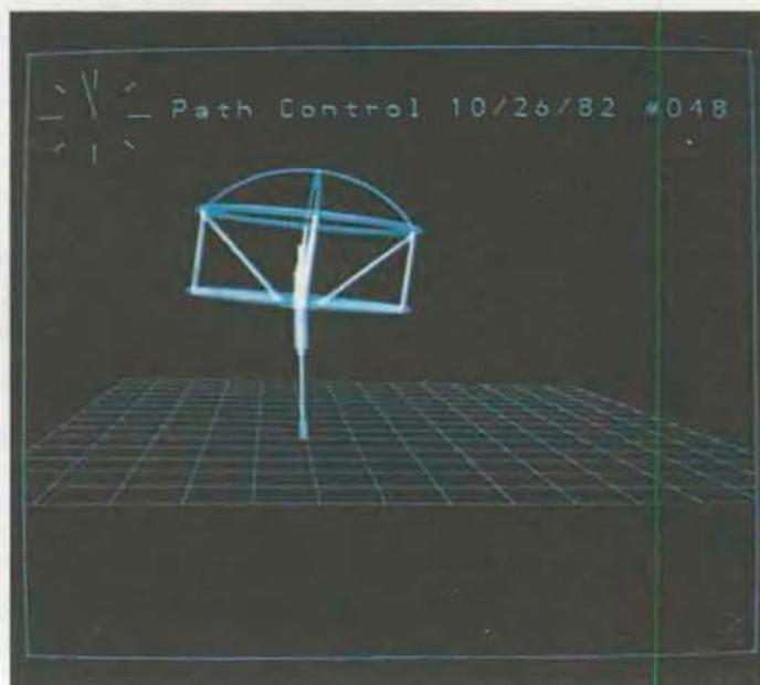
СМОДЕЛИРОВАННОЕ ДВИЖЕНИЕ прыгающей машины, совершающей перемещение в трех плоскостях. Фотографии получены с дисплея ЭВМ, на которой строилась модель
