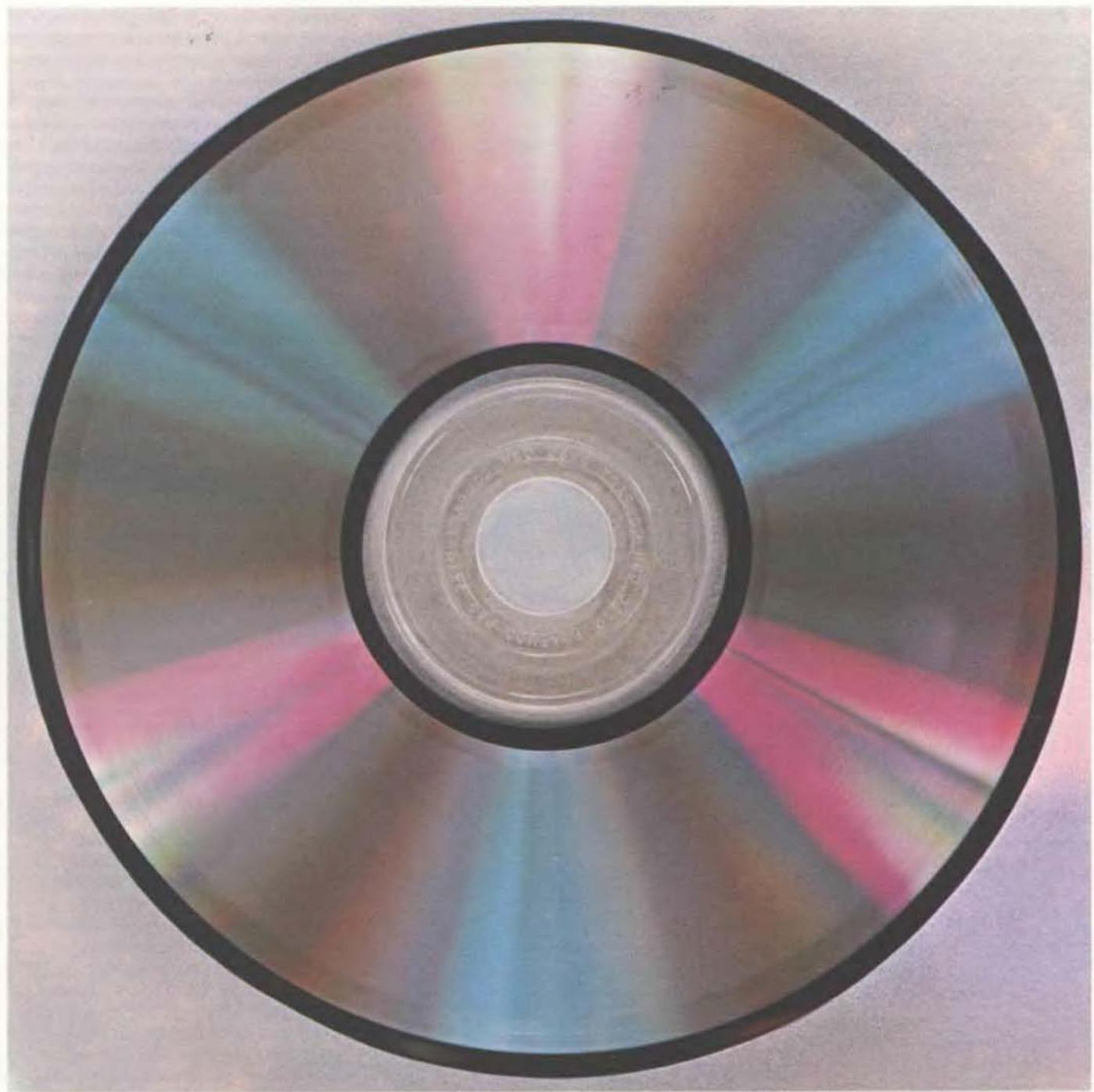
КОМПАКТ-ДИСК для цифрового воспроизведения записи имеет диаметр 120 мм и толщину 1,2 мм. Налажено массовое производство таких дисков. Запись на диске выполнена в цифровой форме: выступы и ровные участки соответствуют двоичным 1 и 0. Считывание записи осуществляется ла-
